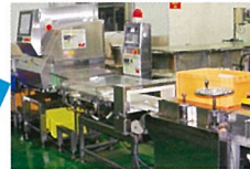
軟X線検査装置で、異 物混入の最終チェック をする。
